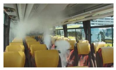
車内換気に よる空気流れ を可視化する ため、煙を充 満させる
